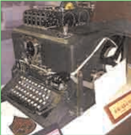
▲ Lo smistatore crittografico Bell 131-B2, "colpevole" di trasmettere segnali spuri in grado di essere rilevati da un potenziale nemico, usato durante l'ultima Guerra Mondiale.
